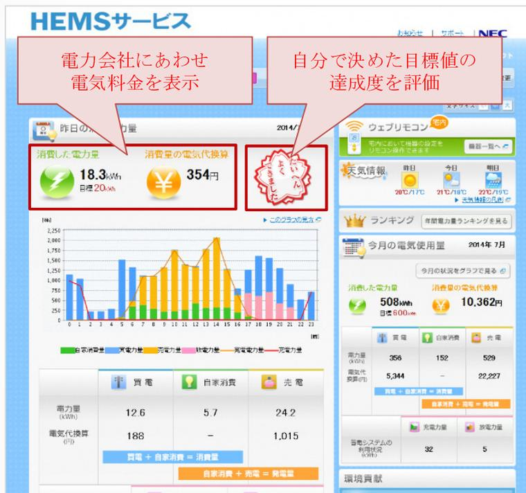
HEMSを導入することで、左図の様に自宅のリアルタイムな消費電力状況や過去のデータとの比較による節電状況、電気代の節約状況などを分かり易く「見える化」します。
