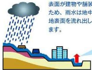
表面が建物や舗装によって覆われているため、雨水は地中へと浸透せず、地表面を流れ出します。
