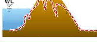
堤体や地盤が大きく変化し、崩壊する場合がある。決壊に至ることが多く、堤体や基礎地盤の液状化によるものと考えられる。
