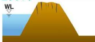
堤体の頂部などにクラック(亀裂)が発生する場合がある。堤体の上下流方向に生じるクラック(亀裂)は水みちとなることがある、特に注意が必要である。
