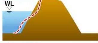
堤体法面の上部が沈下し、下部がはらんで変形が生じる場合がある。
