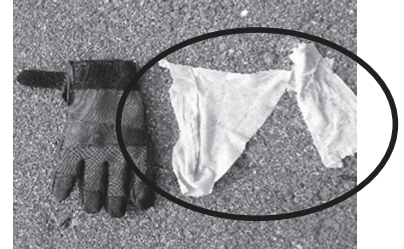
▲水に溶けないシート (下水やポンプ詰まりの原因)
